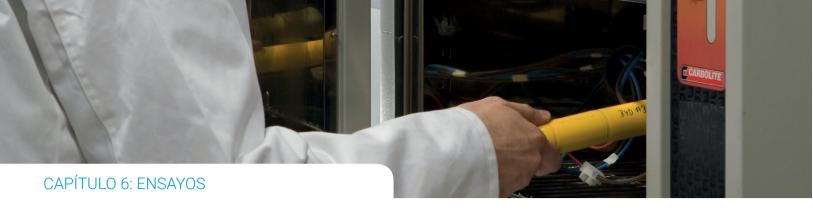
La tensión de ensayo se establece en 1,06 veces la tensión nominal del equipo.
