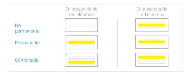
La luminarias de emergencia combinadas eran la alternativa más fiable cuando se requiería alumbrado de emergencia permanente en una instalación. Los tubos fluorescentes en permanente (encendidos tanto en presencia de red eléctrica como en ausencia de ella) tienen una vida media apróximada de 8.000 horas (11 meses aproximadamente). Esto hace que <u>el alumbrado de emergencia permanente mediante tubo fluorescente presente serios problemas de matenimiento y fiabilidad.</u>
